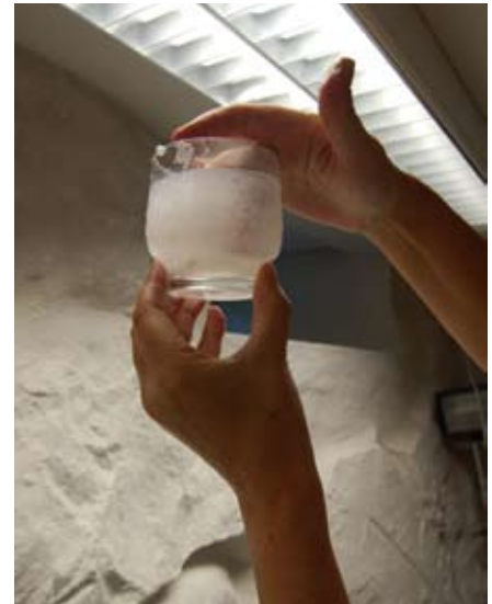
... og sjekk ved gjennomlysning.
