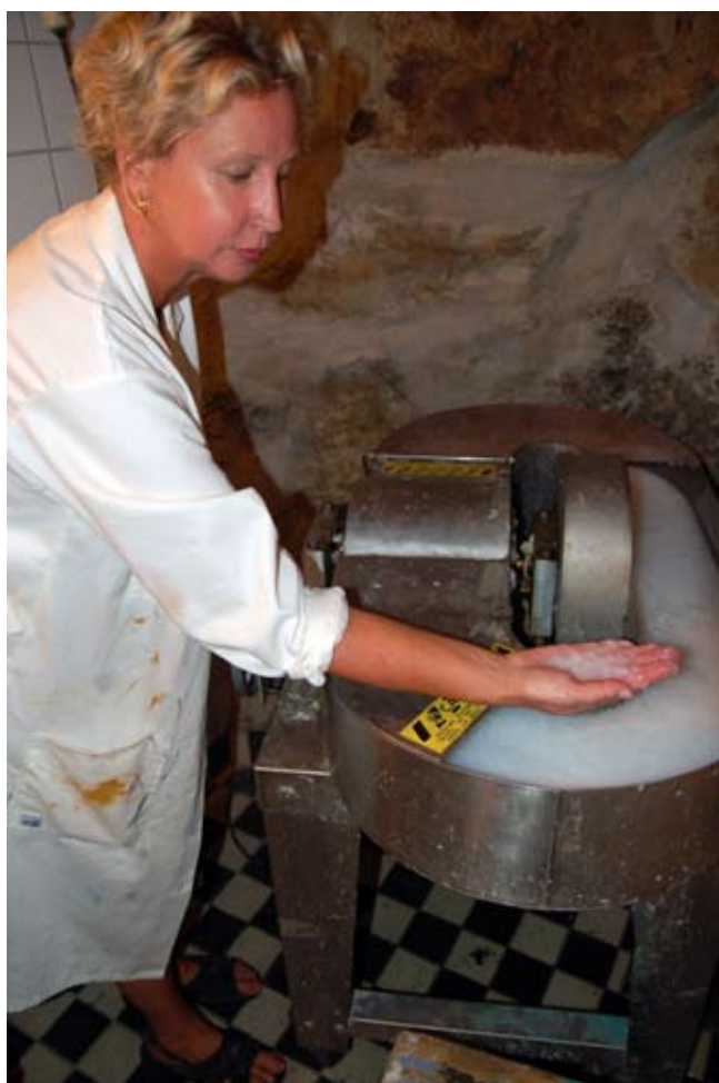
Når hollenderen har gjort jobben og fibrene er klare for å bli til papir, tømmes hollenderen for papirmasse.
