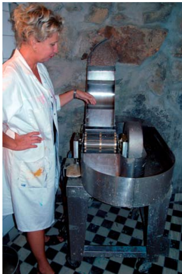
Gabriella åpner dekselet på hollenderen og viser valsen med kniver, som finfordeler fibrene.
