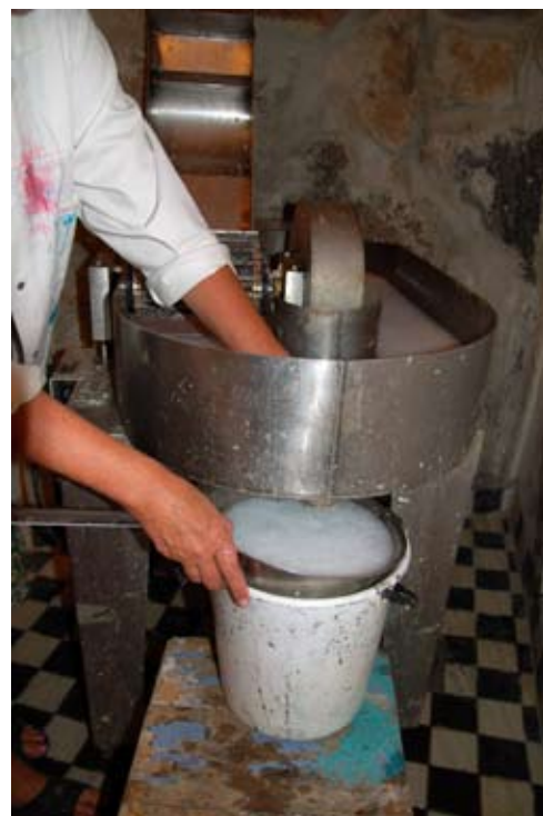
Når hollenderen har gjort jobben og fibrene er klare for å bli til papir, tømmes hollenderen for papirmasse.
